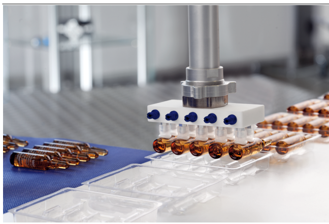
Создание вакуума с помощью эжекторных модулей SEP для перемещения ампул
